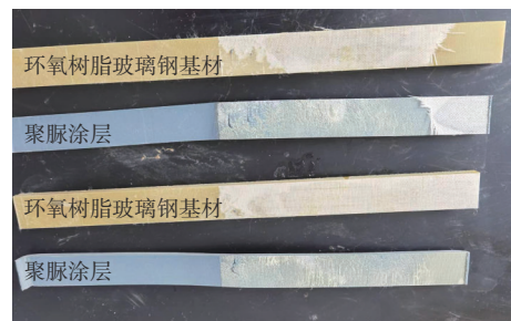
图2 涂覆底漆的环氧树脂玻璃钢底材,底材本体破坏
