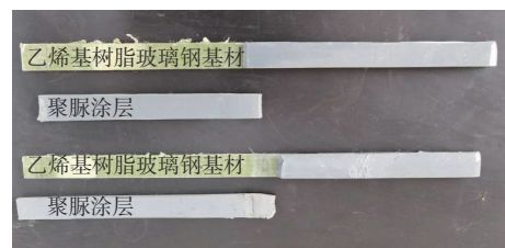
图3 涂覆底漆的乙烯基树脂玻璃钢底材,聚脲本体破坏(断裂)
