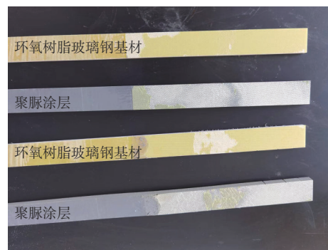
图1 未涂覆底漆的环氧树脂玻璃钢底材,底材表层剥落
